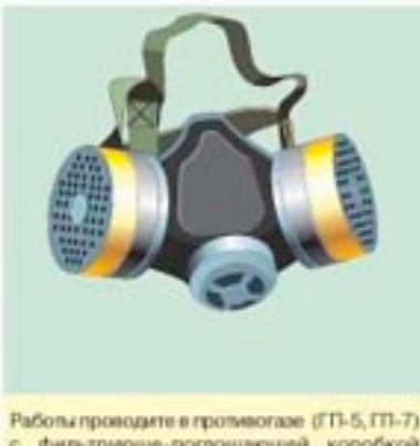
Работы проводите в пропиогазе (ГП-5, ГП-7) с фильтрующе-поглощающей коробкой марки Г (одна половина чёрная, другая — жёлтая) или реагираторе (РУ-60М, РПГ-67) с патронами марки Г (марки патрона нанесена в центре перфорированной сетки)
